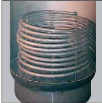
Un intercambiador de calor de tubo liso que tenga las dimensiones adecuadas genera muy pocas turbulencias en el agua de calefacción almacenada de forma que es posible calentar la zona fría de la parte inferior del depósito sin afectar negativamente a la zona más caliente situada por encima de aquella. Sólo después de que las temperaturas de los niveles superior e inferior estén próximas a igualarse, se activará el calentamiento de la zona superior.
